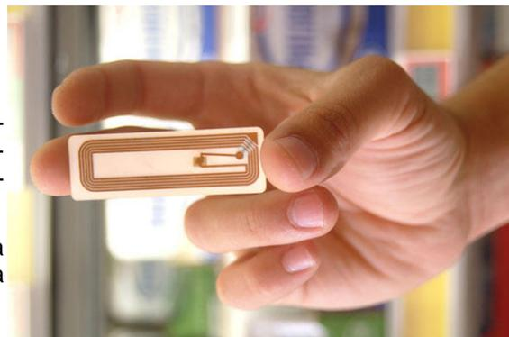
Na figura acima uma Tag (Etiqueta RFID) para colocação nos componentes ou produtos. Esta etiqueta transmite o código de identificação destes ao sistema de monitoramento via ondas eletromagnéticas.
